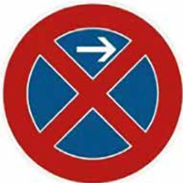
Zvislá dopravná značka: Zákaz zastavenia.
